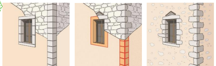
enduit + encadrement et chaîne d'angle droits en pierres de taille apparentes dégrossies
